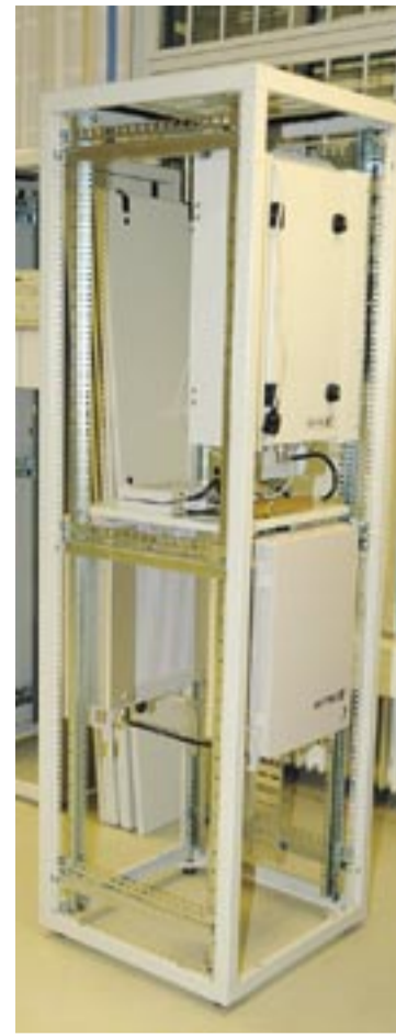
Stativ som dessa innehåller GSM-repeatarer. De ersätter dyrare basstationslösningar i glesbygd.
