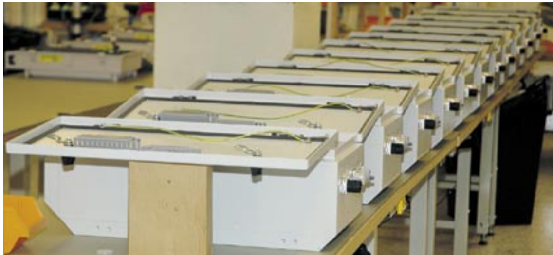
Repeatrarna på bilden har genomgått inbränning och sluttest och är nu färdiga för leverans.
