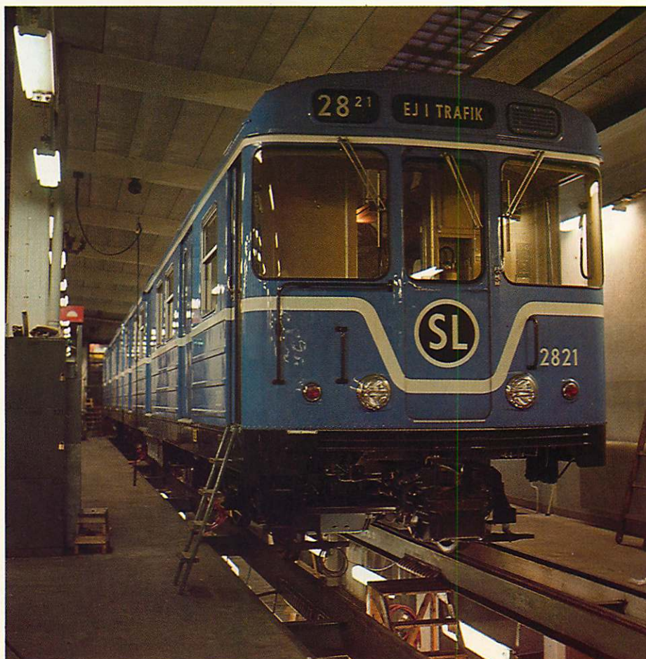
Reparationsgrav med tunnelbanevagn, Rissnehallen
