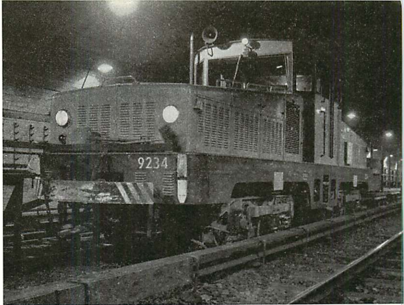
Fig. 9:13. För anläggnings- och underhållsarbeten krävs ett 10-tal arbetslok. Detta är ett 36 tons dieselelektriskt boggielok.
