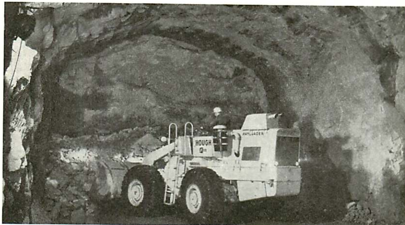
Fig. 8:1:2. Fyrhjulsdriven frontlastare med ca 3 m 3 skopa.
